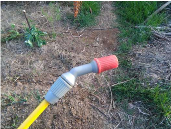
Ilustración 4: Detalle de boquilla regulable
